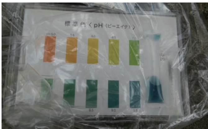
写真1 学校現場で水質調査に用いられるパックテスト（共立理化学）。
