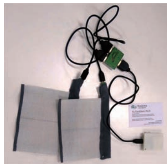
■図2 伸縮センサと回路 センササイズ：約 130 × 70mm（変更可能）
