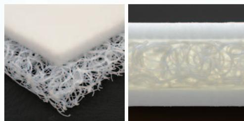
図22 複層クッション材の構造
