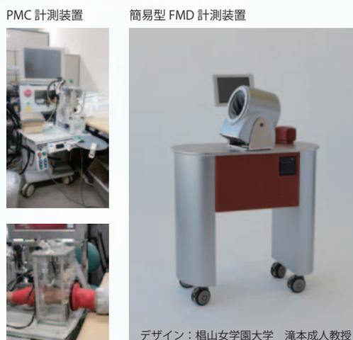
図3 動脈硬化進行度計測システム
