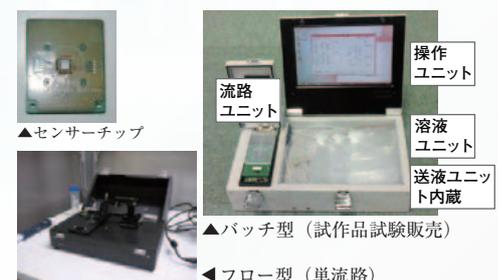
図4 超高感度診断用計測装置
