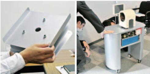
図5 回転・揺動の機構部とモックアップ3
