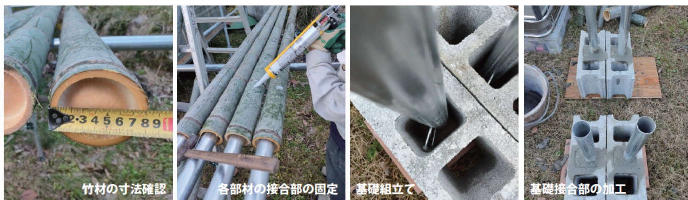
写真_組立試験の様子
